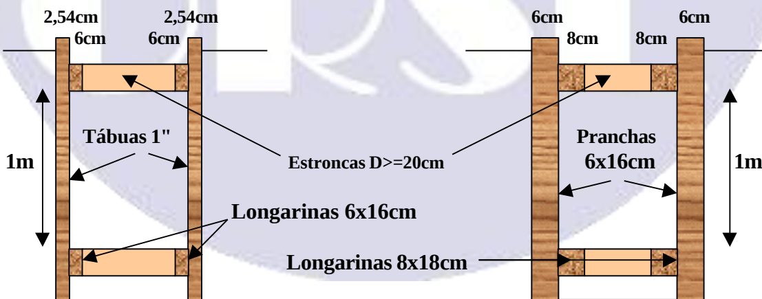
Escoramento contínuo ou descontínuo de madeira até de 2,00m
