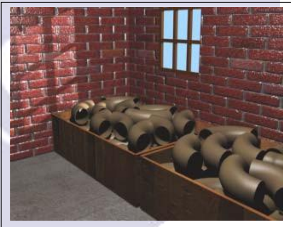
Fig. 01. Armazenagem de conexões em gavetas
