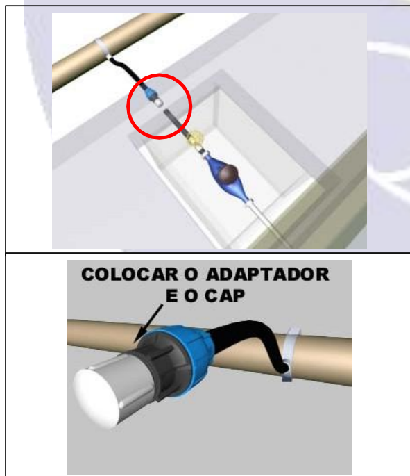
Figura 07. Representação esquemática de "Corte em grande consumidor" sem cavalete
