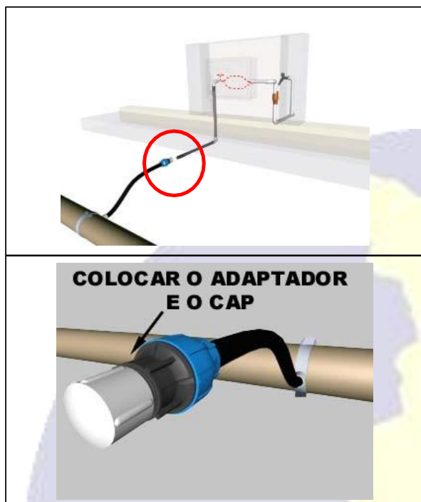
Figura 06. Representação esquemática de "Corte em grande consumidor" em hidrômetros de 10,0m3 a 20,0m3
