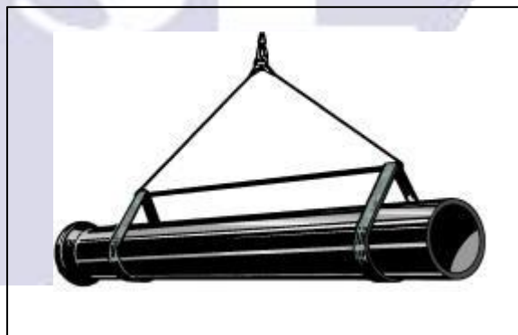
Fig. 02. Movimentação com utilização de cintas e "balancim"
