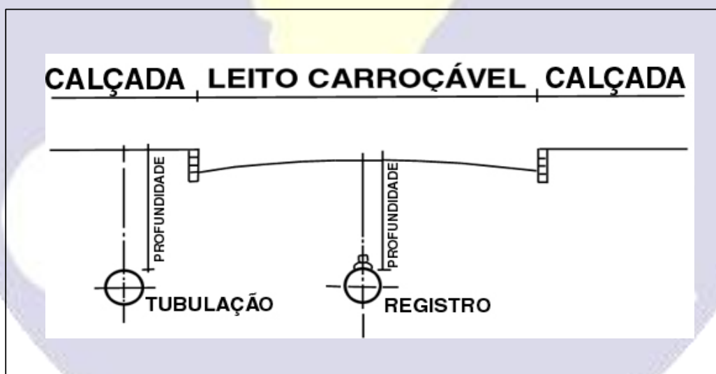
Fig. 16. Determinação da profundidade da tubulação ou peça
