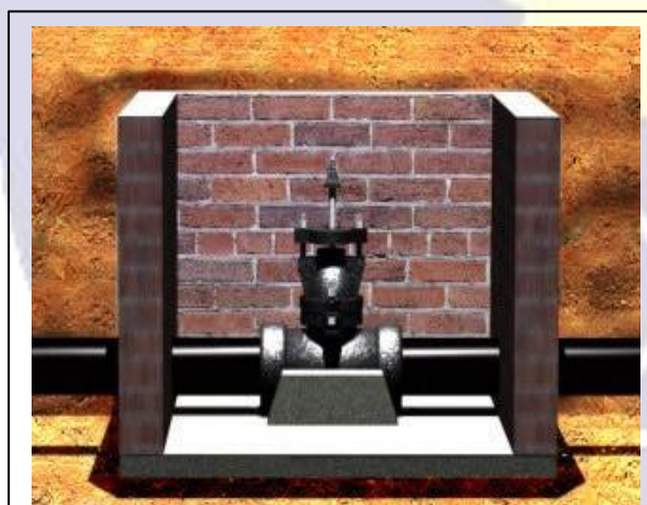
Fig. 07. Ancoragem de registros
