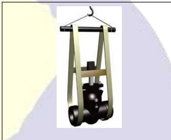
Fig. 01. Movimentação com utilização de cintas e "balancim"
