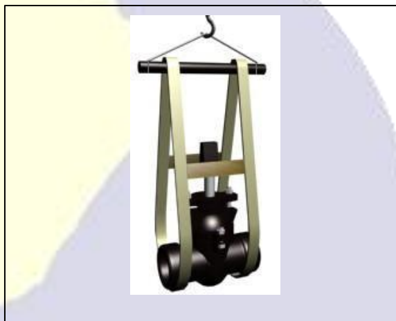
Fig. 01. Movimentação com utilização de cintas e "balancim"
