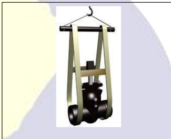
Fig. 01. Movimentação com utilização de cintas e "balancim"
