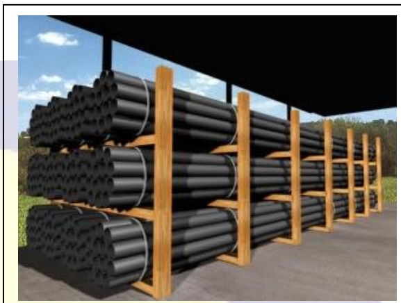
Fig. 04. Estocagem de feixes de barras de tubos
