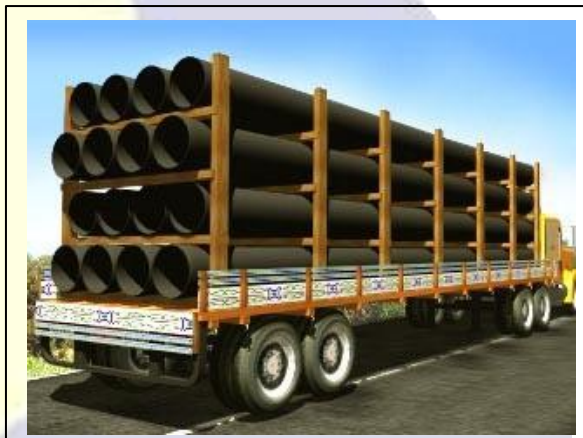
Fig. 01. Transporte de tubos com confinamento lateral.
