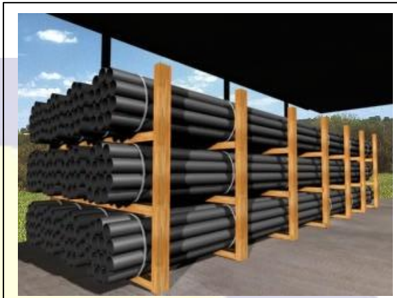
Fig. 04. Estocagem de feixes de barras de tubos
