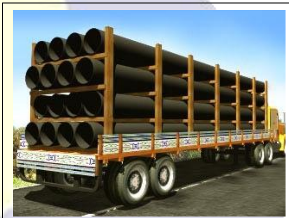
Fig. 01. Transporte de tubos com confinamento lateral.
