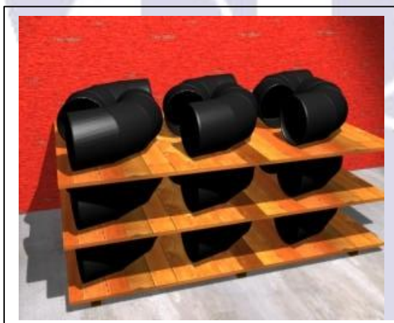
Fig. 04. Armazenagem de conexões em aço
