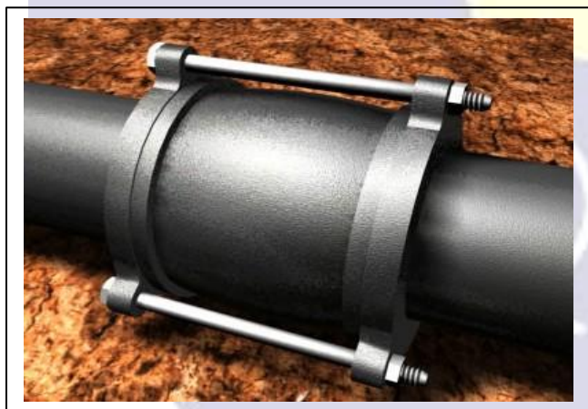
Fig 06. Por fim, serão passados os parafusos, que serão apertados gradualmente e de forma alternada, até a obtenção de uma compressão adequada dos anéis de borracha.
