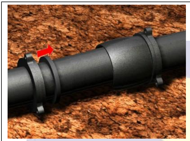
Fig 05. Os anéis de borracha, juntamente com os flanges, serão deslocados até se encontrarem com a luva central.
