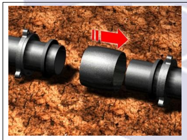
Fig 02. Em uma das extremidades será colocada a luva central da junta, que deverá deslizar com bastante folga sobre a mesma.
