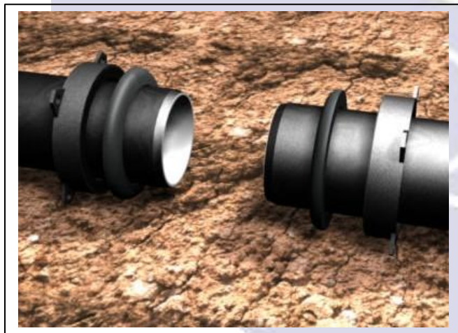
Fig 01. Inicialmente, em cada extremidade de tubo a ser conectada será colocado um contra-flange com seu respectivo anel de vedação.
