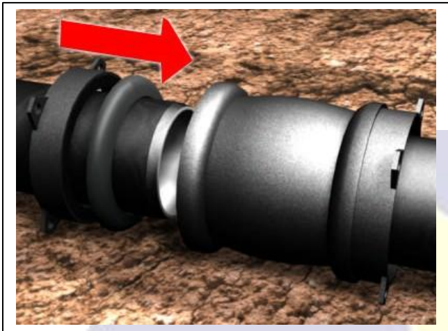
Fig 03. Os tubos serão, então, aproximados e alinhados.
