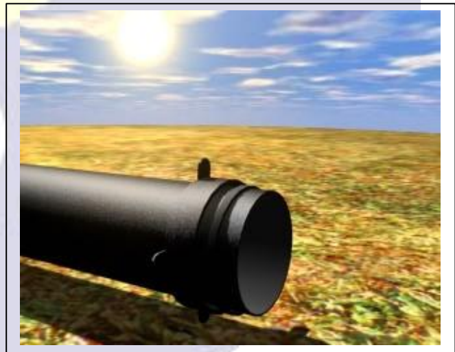
Fig 02. Na extremidade ponta do tubo a ser conectado, o contra-flange será colocado, juntamente com o anel de vedação.
