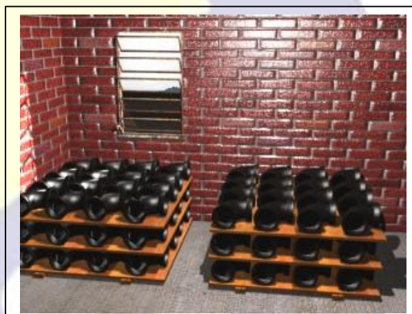
Fig. 06. Armazenagem de conexões em ferro fundido
