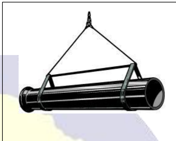
Fig. 02. Movimentação com utilização de cintas e "balancim"
