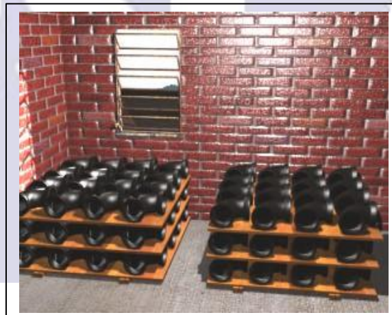
Fig. 04 . Armazenagem das conexões de ferro fundido
