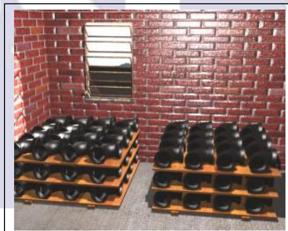
Fig. 04 . Armazenagem das conexões de ferro fundido
