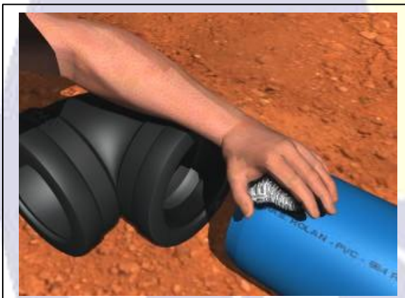
Fig. 10a - Preparo da ponta do tubo A ponta deverá ser limpa e...
