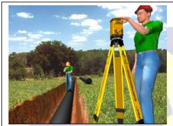
Fig. 04 – Verificação das Cotas
