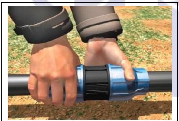
Fig. 46 - As porcas de extremidade serão apertadas manualmente.
