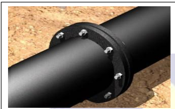
Fig. 07a - ... Será, então, executada a aproximação dos flanges, através de um aperto inicial nos parafusos, cujo objetivo é apenas adaptar a arruela às superfícies dos flanges, moldando-a a todas as imperfeições ou irregularidades que possam existir nos mesmos....
