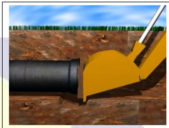
Fig. 13 - Poderá ser utilizada a força hidráulica do braço da escavadeira na montagem dos tubos. Neste caso, deverá ser utilizada uma prancha de madeira entre o tubo e a caçamba. O esforço deverá ser aplicado de forma lenta e contínua.
