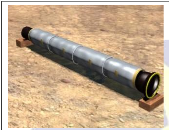
Fig. 12 - A dobra e as extremidades da manta serão presas com fita adesiva, sendo a última fixada em toda a circunferência do tubo. Será, ainda, utilizado um fio de aço plastificado, amarrando a manta ao tubo, a cada 1,50m.
