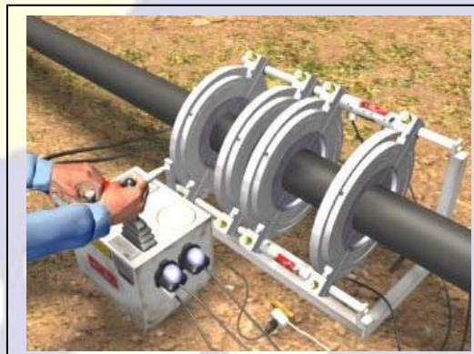
Fig. 18 - A pressão de solda necessária deverá ser verificada nas especificações técnicas do fabricante e somada à pressão inicial para deslocamento do conjunto (inércia da máquina adicionada ao peso próprio do tubo a ser deslocado) .
