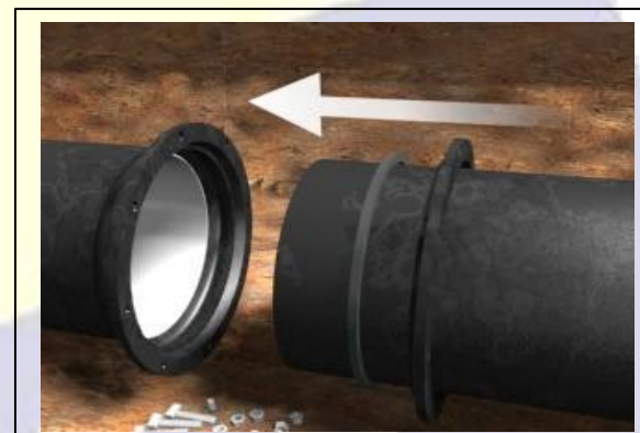
Fig. 04 - Aproximação dos tubos
