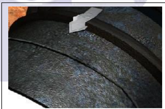
Fig. 05 - Deverá ser utilizada uma cunha para facilitar a passagem do anel sobre o cordão.
