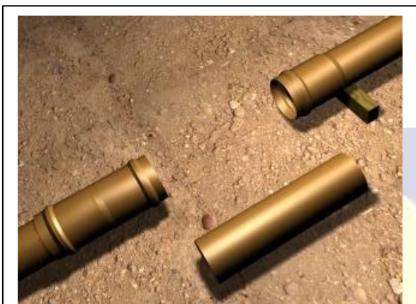
Fig. 12 - Deverá ser providenciado um pedaço de tubo do tamanho do trecho removido
