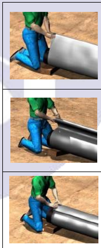
Fig. 10 - Deverá ser assegurado que a dobra seja feita na geratriz superior do tubo, a fim de eliminar os riscos de danos que podem ocorrer, durante o recobrimento da canalização, devido à penetração de terra na dobra.
