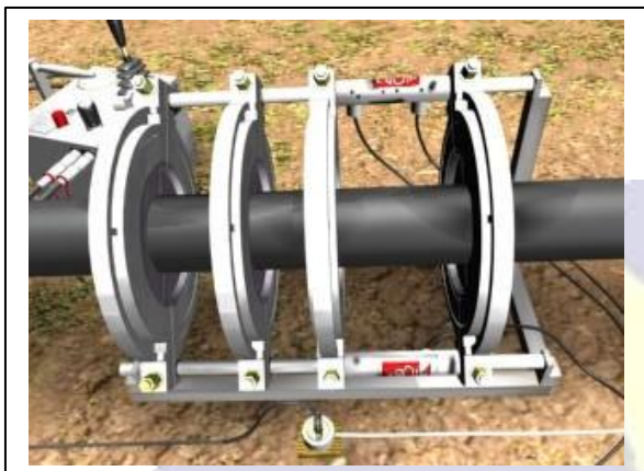
Fig. 25 - A placa de aquecimento deverá ser retirada e os tubos aproximados. O cordão de solda instantaneamente aumentará de dimensão.
