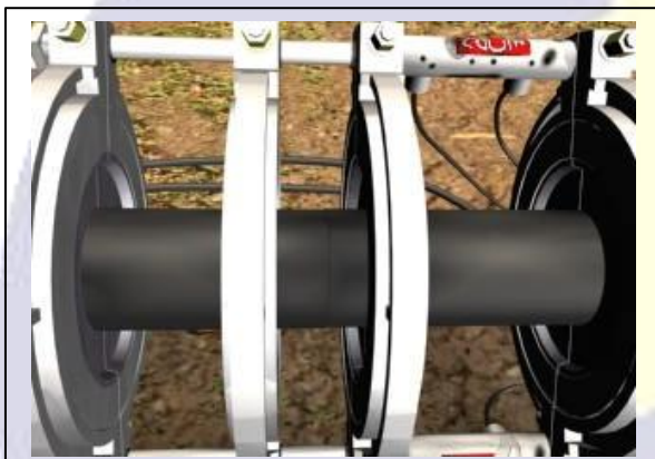
Fig. 21 - Os tubos serão aproximados, devendo o alinhamento, ser novamente verificado. A operação deverá ser repetida, até se conseguir o perfeito alinhamento.
