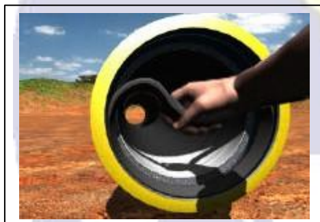
Fig. 02a - Colocação do anel de borracha
