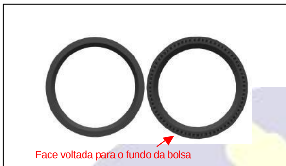
Fig. 03 - Observar que a face mais larga do anel, na qual se localizam os furos, deverá ficar voltada para o fundo da bolsa.
