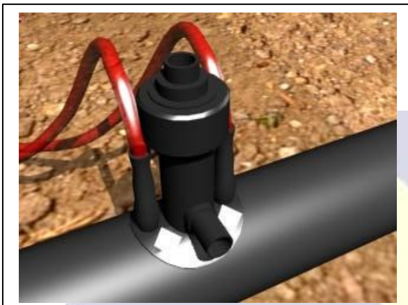
Fig. 41 - Por fim, a soldagem poderá ser executada.
