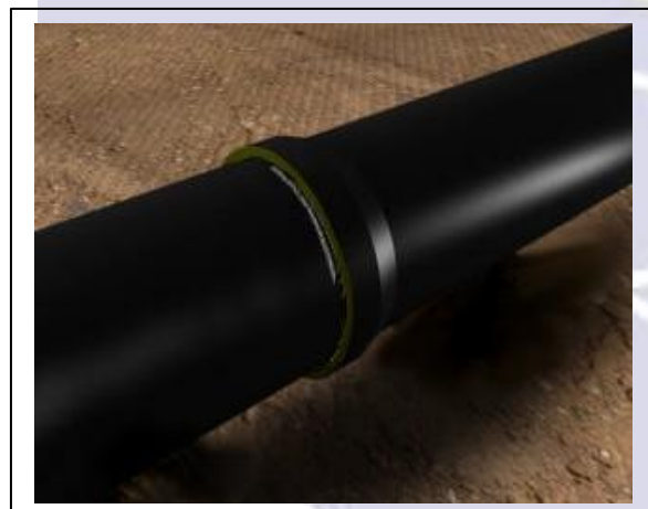
Fig. 09 - O tubo será movido para dentro da bolsa até que a marca de giz se encontre com a borda da bolsa. Esta posição deverá ser mantida possibilitando, desta forma, a flexibilidade da junta.
