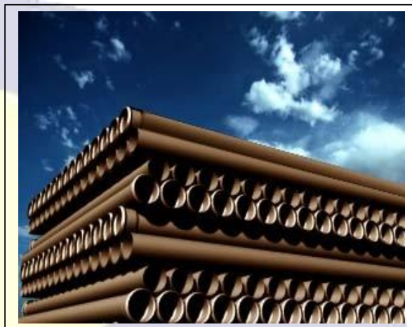
Fig. 03. Empilhamento em camadas cruzadas
