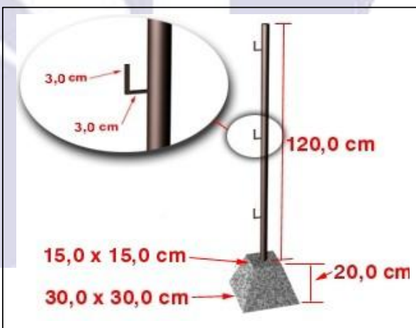
Fig. 02. Detalhe do pedestal
