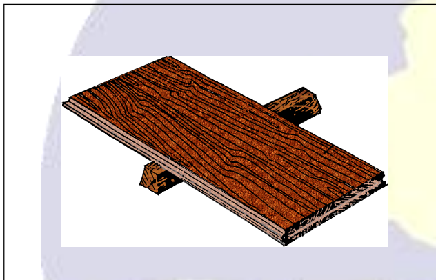
Fig. 01. Posicionamento das régulas de madeira sobre os barrotes
