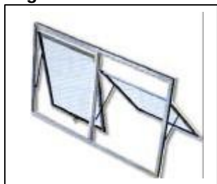
Figura 03. Janela tipo maxim-ar duplo
