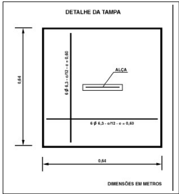
Figura 11. Caixa de Passagem CP 40- 60 – Tampa
