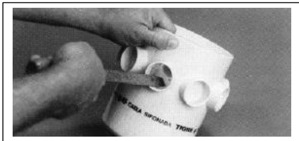
Fig. 10. Arremate final com lima meia-cana ou rasqueta
