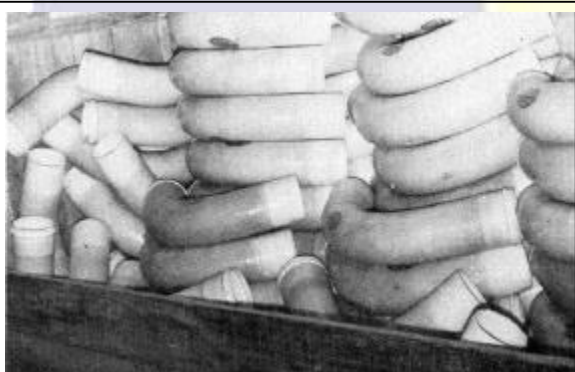
Figura. 08. Armazenagem de conexões em escaninhos
