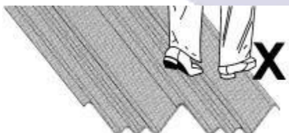
Figura 115. As abas das telhas não resistem a cargas concentradas
