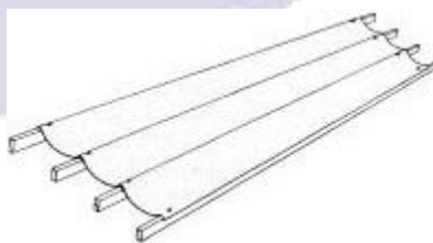
Figura 94. Fixação em longarinas.
