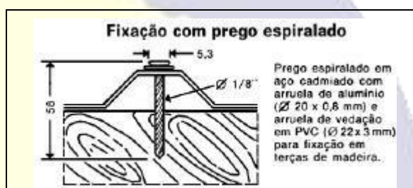
Figura 25. Fixação com prego espiralado
