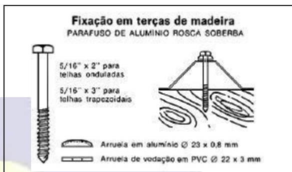
Figura 24. Fixação em terças de madeira
