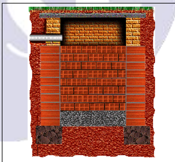
Figura 26. Alvenaria de bloco cerâmico 06 furos em sumidouros
