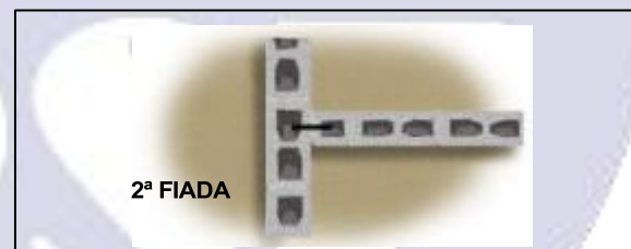
Figura 11. Amarração com Grampos – 2ª Fiada
