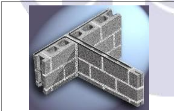
Figura 16. Amarração de Painéis com Armadura
