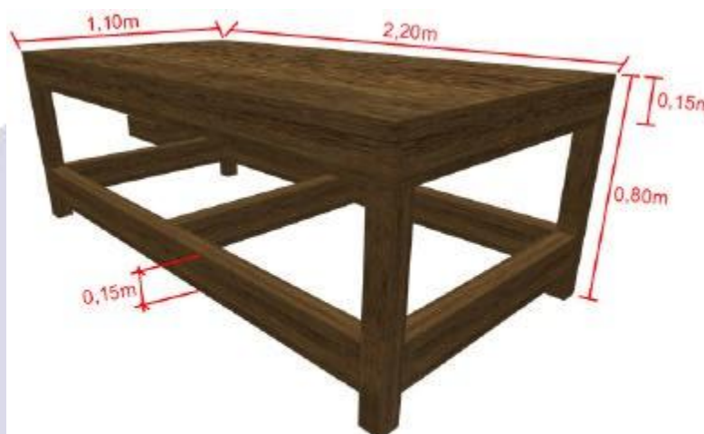
MESA EM CHAPA COMPENSADO PARA REFEITÓRIO DE OBRA
